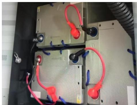
4. Нанесите на каждую стойку защитную смазку. Поместите защиту клемм аккумулятора на все стойки.
